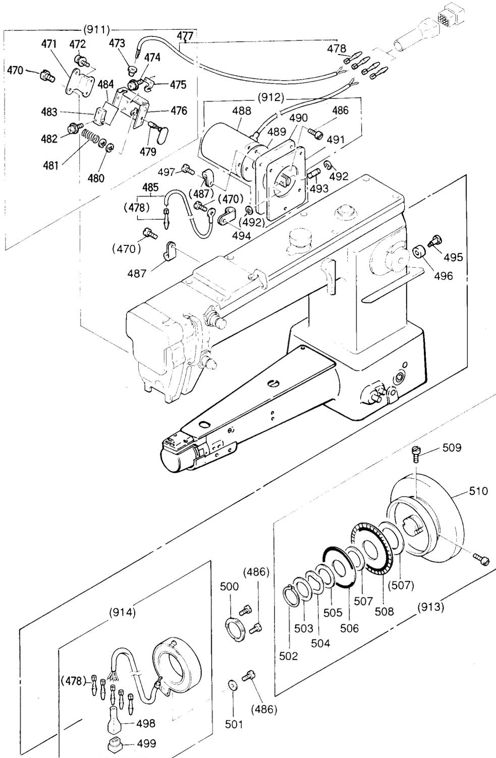
[J] タッチバック機構および検出器機構
